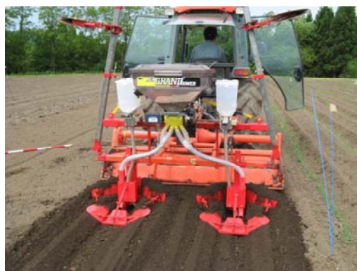
長ネギの施肥同時溝切り機(特許3817527号)
